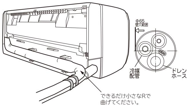
④ Fケーブル、配管を整形し、室内機背面の下部スペースに納め、
