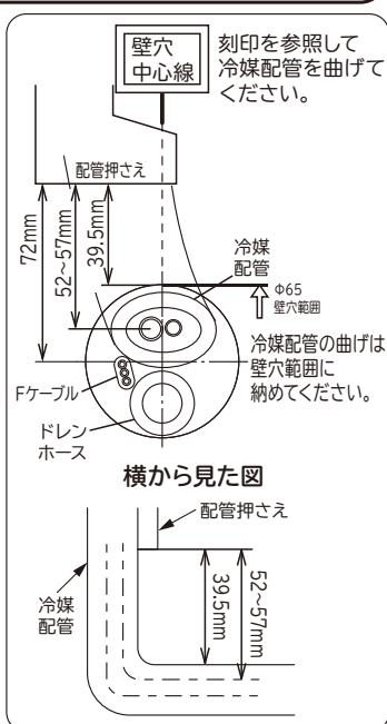
冷媒配管の曲げ始めが壁穴範囲から出でていたり、曲げRが大きいと、室内機が壁から浮き上がり、仕上りが悪くなる原因となります。
