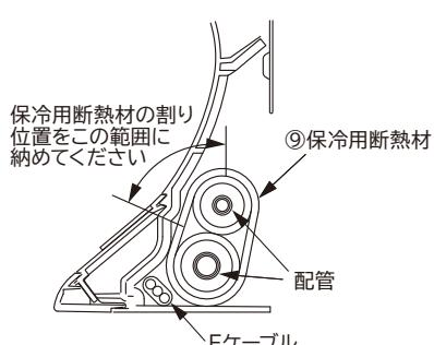
③ 冷媒配管を壁穴位置に合わせて整形します。
