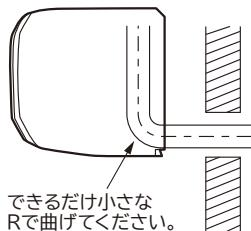
冷媒配管の曲げ始めが壁穴範囲から出でていたり、曲げRが大きいと、室内機が壁から浮き上がり、仕上りが悪くなる原因となります。
