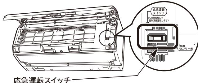
(5秒以上押し続けると強制冷房運転を開始します。止める時は、もう一度押すか、リモコンで運転を停止してください。)
