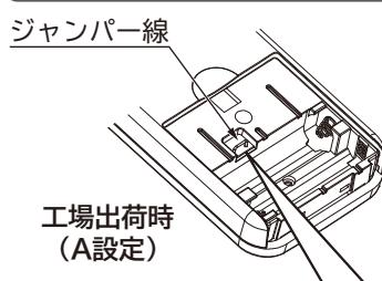
ジャンパー線が切断されている場合は、「B」に設定されています。
