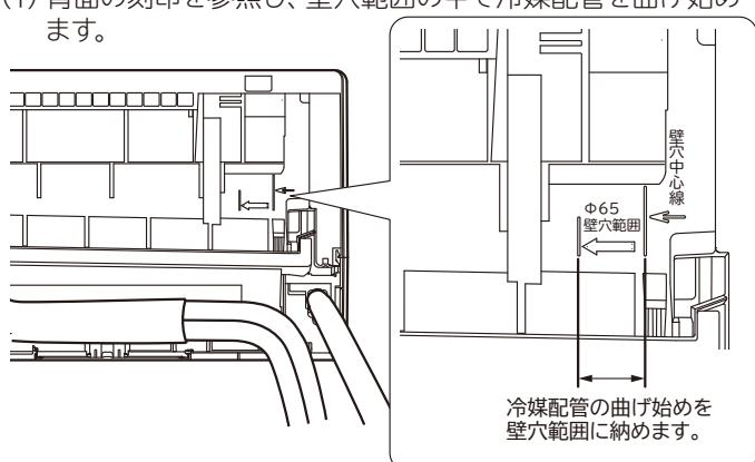
冷媒配管の曲げ始めが壁穴範囲から出ていると、曲げRが大きいと、室内機が壁から浮き上がり、仕上りが悪くなる原因となります。
