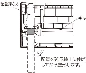
配管を延長線上に伸ばしてから整形します。
