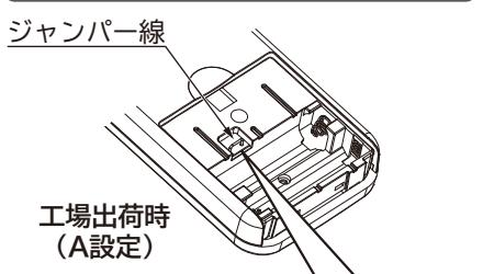
ジャンパー線が切断されている場合は、「B」に設定されています。
