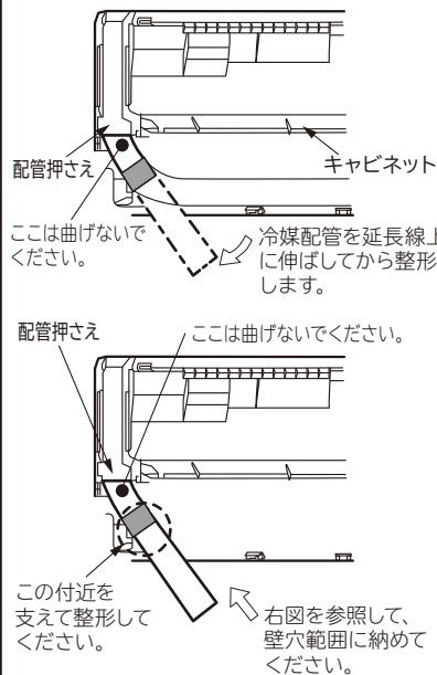
冷媒配管の曲げ始めが壁穴範囲から出でていたり、曲げRが大きいと、室内機が壁から浮き上がり、仕上りが悪くなる原因となります。
