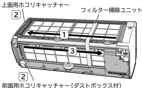
説明のため、フロントパネルを取り外しています。けがや故障の原因になりますので、フロントパネルを取り外したり、開けたままで、フィルターの掃除をしないでください。
