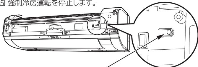
（5秒以上押し続けると強制冷房運転を開始します。止めるときは、もう一度押すか、リモコンで運転を停止してください）
