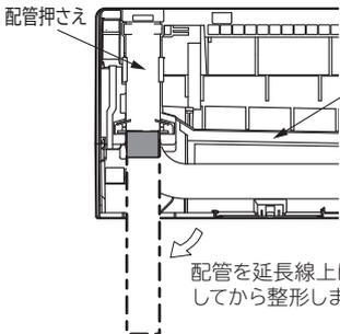
配管を延長線上に伸ばしてから整形します。
