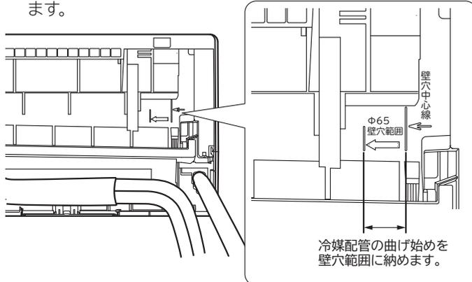
冷媒配管の曲げ始めが壁穴範囲から出ていたり、曲げRが大きいと、室内機が壁から浮き上がり、仕上がりが悪くなる原因となります。
