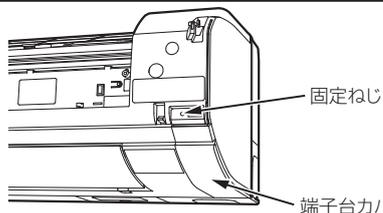
フロントパネルを閉めるときは、フロントパネルの左右2か所を「カチッ」という音がするまで押し付けてください。
