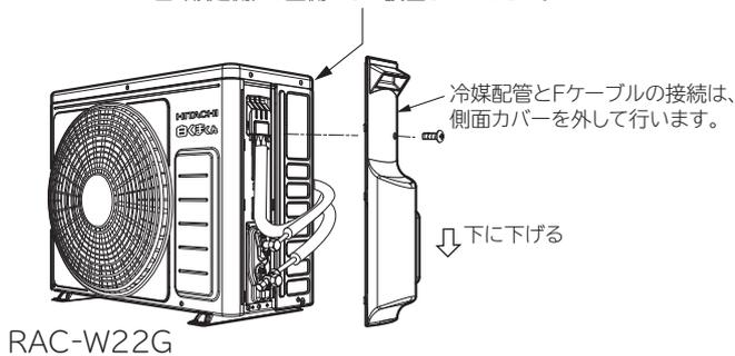
この面(吸込側)を壁側にして設置してください。冷媒配管とFケーブルの接続は、側面カバーを外して行います。
