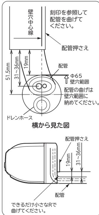
配管の曲げ始めが壁穴範囲から出ている、曲げRが大きいと、室内機が壁から浮き上がり、仕上がりが悪くなる原因となります。
