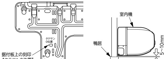
「たてさん」を使用して、室内機の背面で冷媒配管を接続する場合は、右図のように施工してください。
