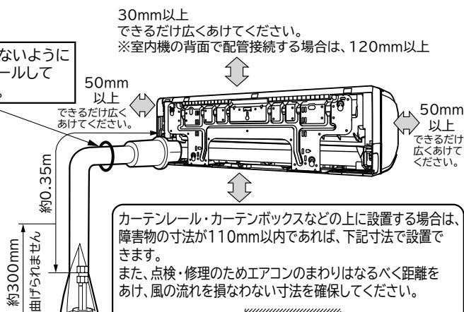
カーテンレール・カーテンボックスなどの上に設置する場合は、障害物の寸法が110mm以内であれば、下記寸法で設置できます。
