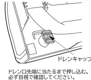
ドレン口先端に当たるまで押し込む。必ず目視で確認してください。
