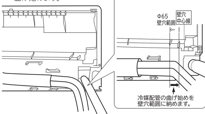
冷媒配管の曲げ始めが壁穴範囲から出ていたり、曲げが大きいと、室内機が壁から浮き上がり、仕上りが悪くなる原因となります。
