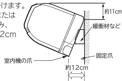
配管接続のときは、下カバー中央を外すと接続が容易になります。
