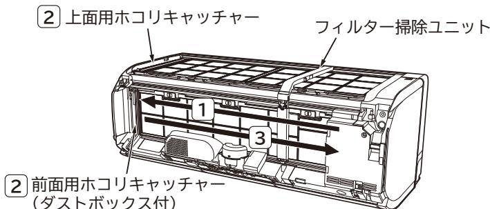
説明のため、フロントパネルを取り外しています。けがや故障の原因になりますので、フロントパネルを取り外したり開けたままで、フィルターの掃除をしないでください。
