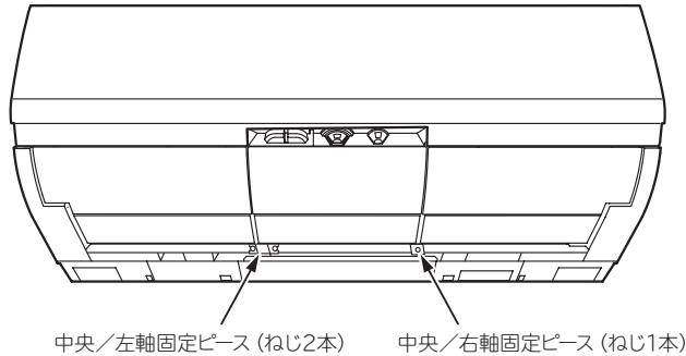
⑥ 中央／左軸固定ピースと中央／右軸固定ピースを外します。
