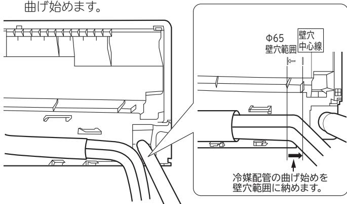
**冷媒配管の曲げ始めが壁穴範囲から出していたり、曲げが大きいと、室内機が壁から浮き上がり、仕上りが悪くなる原因となります。**
