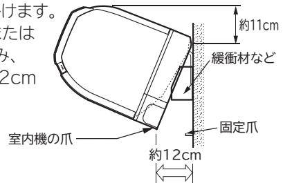
配管接続のときは、下カバー中央を外すと接続が容易になります。
