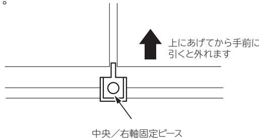
⑦ 後側上下風向板(中央)を手前に引きながら後側上下風向板(右)(左)から固定ピースの軸を抜いて外します。
