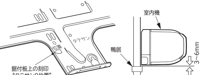
「たてさん」を使用して、室内機の背面で冷媒配管を接続する場合は、下の図のように施工してください。
