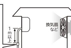
気密性の高い住宅等で強風時や換気扇を使用したときなどに、ドレン水がスムーズに流れず、異音(ポコポコ音など)が発生したり、水漏れが発生することがあります。
