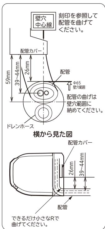
配管の曲げ始めが壁穴範囲から出でていたり、曲げRが大きいと、室内機が壁から浮き上がり、仕上りが悪くなる原因となります。
