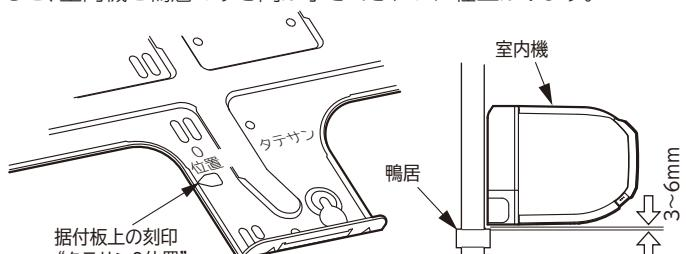
「たてさん」を使用して、室内機の背面で冷媒配管を接続する場合は、右の図のように施工してください。
