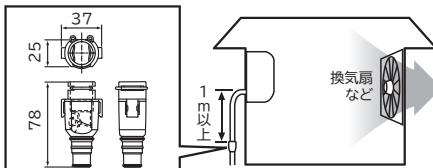
気密性の高い住宅等で強風時や換気扇を使用したときなどに、ドレン水がスムーズに流れず、異音(ポコポコ音等)が発生したり、水漏れが発生することがあります。
