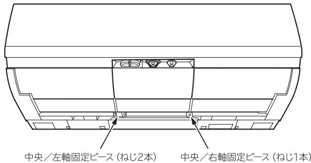
④ 中央／左軸固定ピースと中央／右軸固定ピースを外します。
