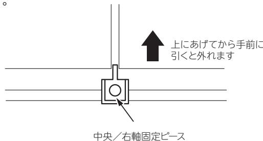
⑤ 後側上下風向板(中央)を手前に引きながら後側上下風向板(右)(左)から固定ピースの軸を抜いて外します。
