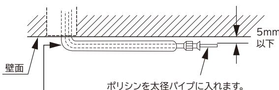
できるだけ小さなRで曲げてください。(PVCを使用すると配管を潰さずに小さなRで曲げることができます。)
