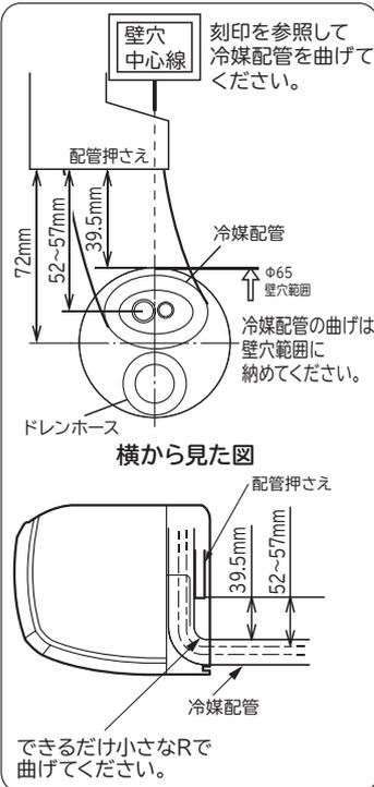
冷媒配管の曲げ始めが壁穴範囲から出ていると、室内機が壁から浮き上がり、仕上がりが悪くなる原因となります。
