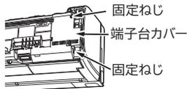
フロントパネルを閉めるときは、フロントパネルの左右2カ所を先に、その後中央部（2カ所）を「カチッ」という音がするまで押し付けてください。
