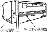
④冷媒配管を接続します(P.9の「配管の接続・エアパージ」を参照)。
