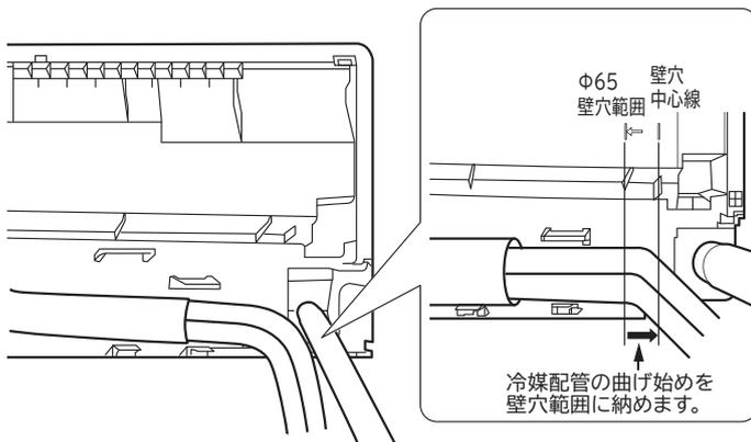
冷媒配管の曲げ始めが壁穴範囲から出ていたり、曲げRが大きいと、室内機が壁から浮き上がり、仕上がりが悪くなる原因となります。
