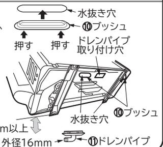
寒冷地等で寒さが厳しく積雪等が多いと、熱交換器から出る水がベース表面に凍結し、排水が悪くなる場合があります。このような地域では、⑩プッシュ・⑩ドレンパイプは取り付けないでください。また、水抜き穴と地面との距離を250mm以上確保してください。
