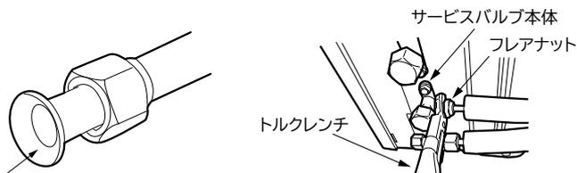
フレア内面のみ冷凍機油(市販品)をこくわずに塗布してください。
