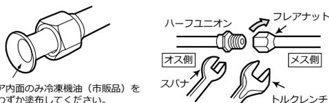
フレア内面のみ冷凍機油(市販品)をこくわずに塗布してください。
