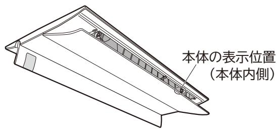
【製造年】は室内機の銘板の中に西暦4桁で表示しています。
