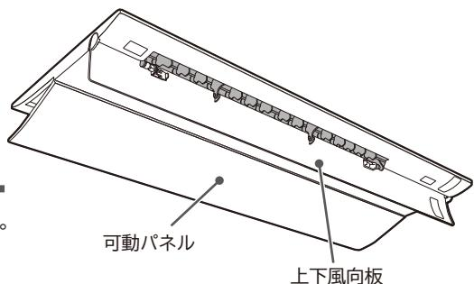
室内機から受信音が「ピッ」と鳴り、「運転」ランプが点灯して、運転を開始します。リモコンに運転内容が表示されます。また、室内機の上下風向板と可動パネルが自動的に開きます。
