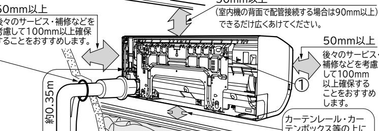
カーテンレール・カーテンボックス等の上に設置する場合は、風の流れを損なわない寸法を確保してください。
