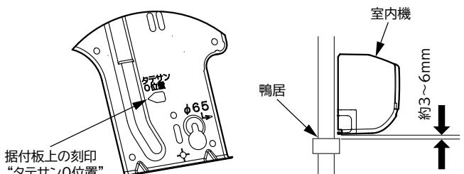
「たてさん」を使用して、室内機の背面で冷媒配管を接続する場合は、下の図のように実行してください。
