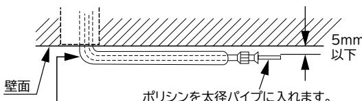
できるだけ小さなRで曲げてください(ポリシンを使用すると配管を潰さずに小さなRで曲げることができます)。
