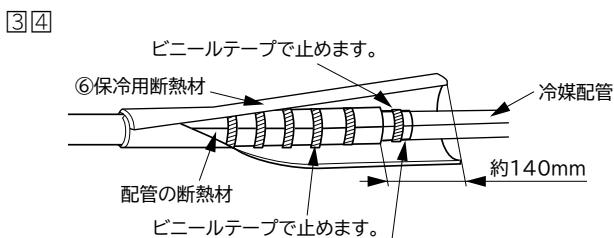
既設の冷媒配管を使用し、冷媒配管の断熱材と配管の断熱材の間にすき間がある場合、切り取った冷媒配管の断熱材と同等品をすき間がないよう巻いてください (現地調達)。
