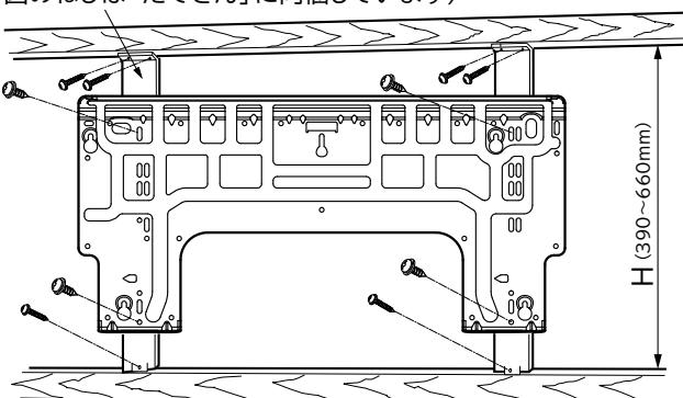
「たてさん」を使用して、室内機の背面で冷媒配管を接続する場合は、下の図のように実行してください。
