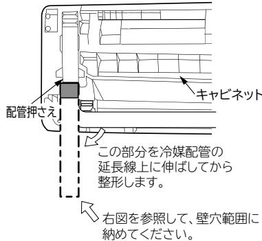
冷媒配管の曲げ始めが壁穴範囲から出ていたり、曲げRが大きいと、室内機が壁から浮き上がり、仕上りが悪くなる原因となります。
