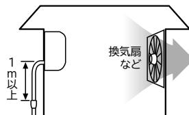
気密性の高い住宅などで強風時や換気扇を使用したときなどに、ドレン水がスムーズに流れず、異音(ポコポコ音など)が発生したり、水漏れが発生することがあります。
