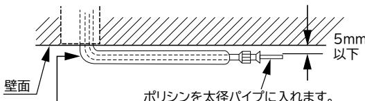
できるだけ小さなRで曲げてください (ポリシンを使用すると配管を潰さずに小さなRで曲げることができます)。
