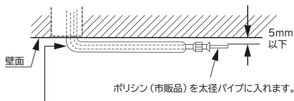
できるだけ小さなRで曲げてください(ポリシンを使用すると配管を潰さずに小さなRで曲げることができます)。
