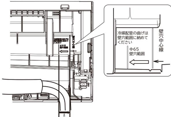
冷媒配管の曲げ始めを壁穴範囲に納めてください。
