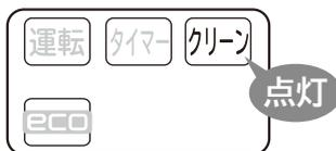
●動作確認運転中や運転後に「クリーン」ランプが点滅（4秒点灯／1秒消灯）表示したときは「フィルター掃除運転」の異常による停止です。
