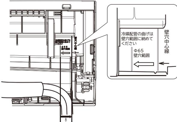
冷媒配管の曲げ始めを壁穴範囲に納めてください。
