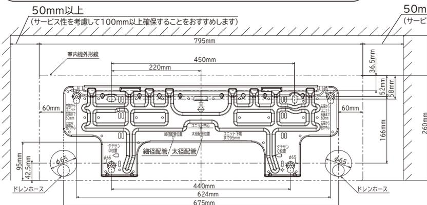
「たてさん」を使用して、室内機の背面で冷媒配管を接続する場合は、下図のように施行してください。
