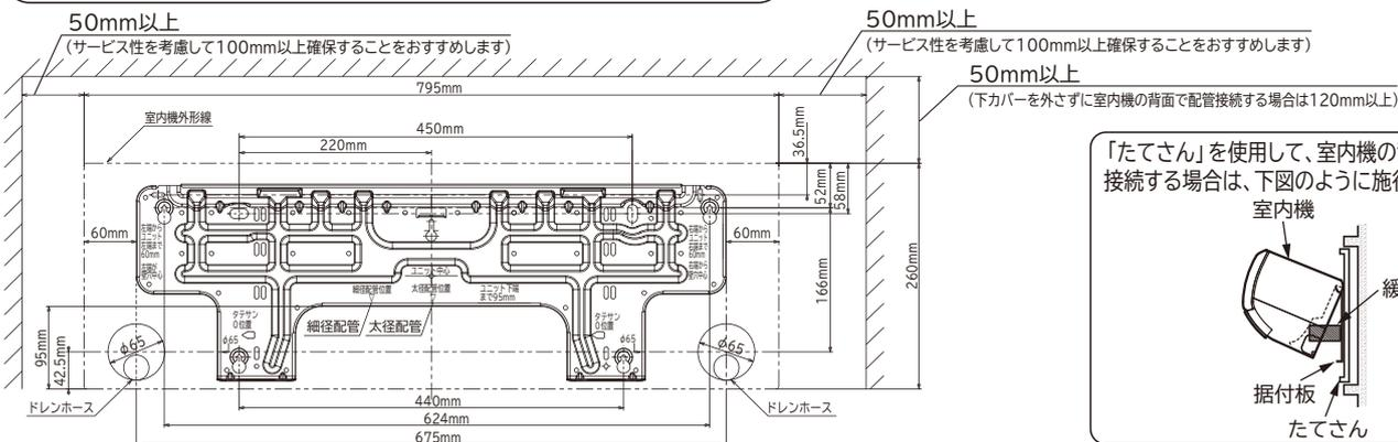
「たてさん」を使用して、室内機の背面で冷媒配管を接続する場合は、下図のように施行してください。
