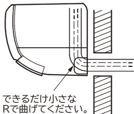
冷媒配管の曲げ始めが壁穴範囲から出ていたり、曲げRが大きいと、室内機が壁から浮き上がり、仕上がりが悪くなる原因となります。
