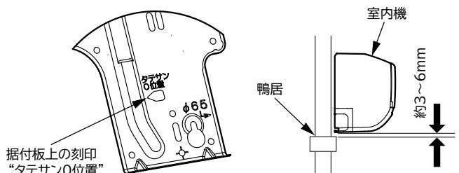
「たてさん」を使用して、室内機の背面で冷媒配管を接続する場合は、下の図のように施行してください。
