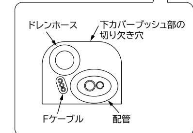
冷媒配管の曲げ始めが壁穴範囲から出ていたり、曲げRが大きいと、室内機が壁から浮き上がり、仕上りが悪くなる原因となります。
