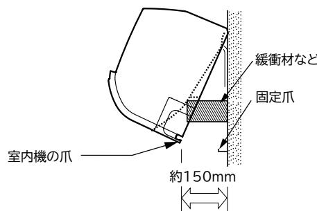
※室内機の下部を手前に浮かして、室内機の背面で冷媒配管を接続する作業が難しい場合があります。この場合は、当据付説明書のP.15に記載しています「フロントパネル・化粧カバーの着脱のしかた」を参考し、化粧カバーを取り外して配管の接続を実施してみてください。
