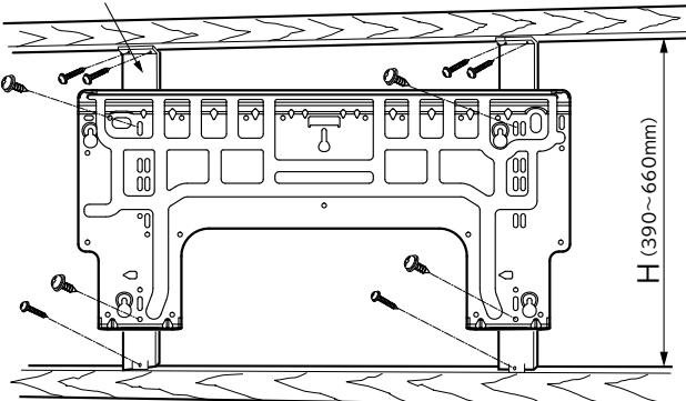
据付板の刻印“タテサン0位置”を「たてさん」上の目盛“0”に合わせると、室内機と鴨居のすき間が小さくきれいに仕上ります。
