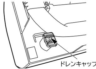
ドレン口先端に当たるまで押し込む。必ず目視で確認してください。
