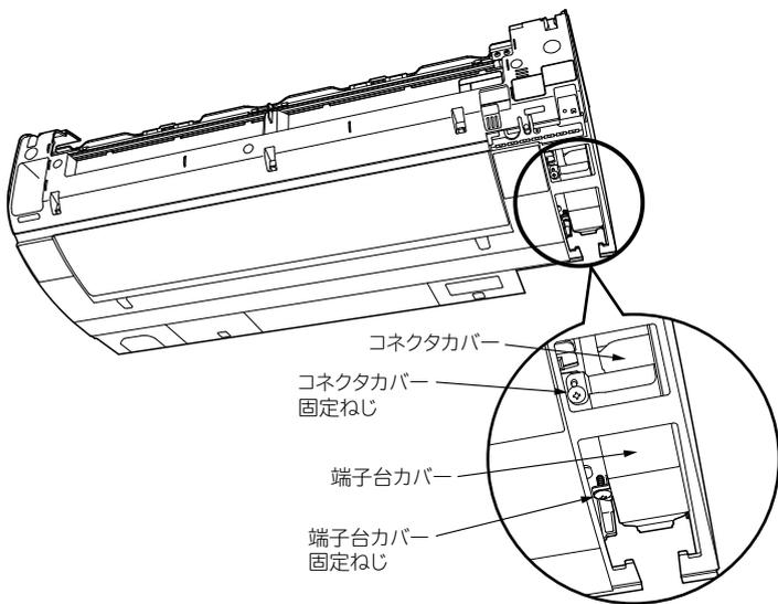
②HAシステムはCN6、RACアダプター・HEMSアダプター・無線LAN接続アダプターはCN7に接続し、下図のように、ケーブルクリップで固定します。
