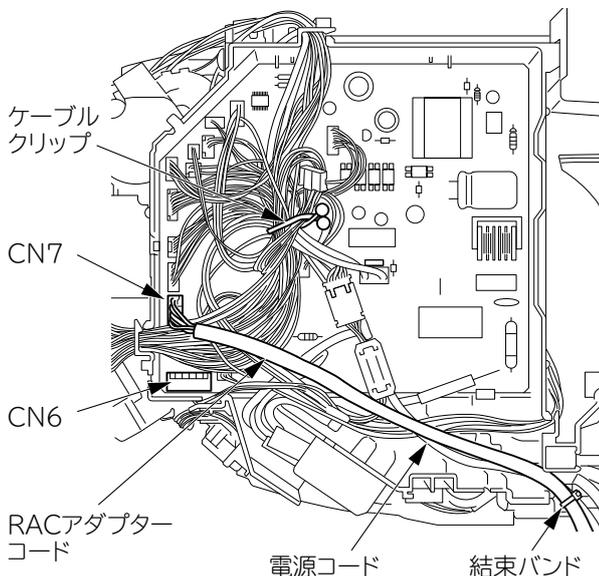
●上図はCN7にH-LINKを接続し、配線した時の例
