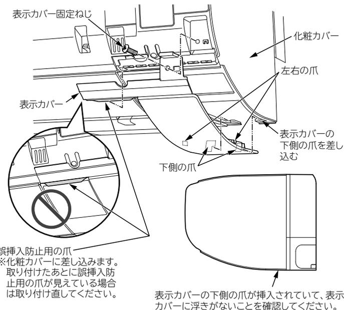
表示カバーの下側の爪が挿入されていて、表示カバーに浮きがないことを確認してください。
