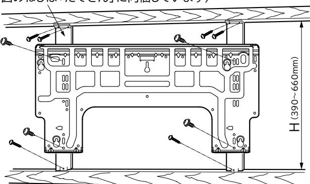
「たてさん」を使用して、室内機の背面で冷媒配管を接続する場合は、下の図のように実行してください。
