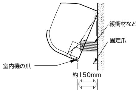
※室内機の下部を手前に浮かして、室内機の背面で冷媒配管を接続する作業が難しい場合があります。この場合は、当据付説明書P.15に記載しています「フロントパネル・化粧カバーの着脱のしかた」を参考し、化粧カバーを取り外して配管の接続を実施してみてください。
