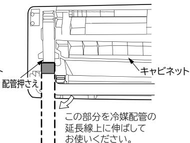
この部分を冷媒配管の延長線上に伸ばしてお使いください。
