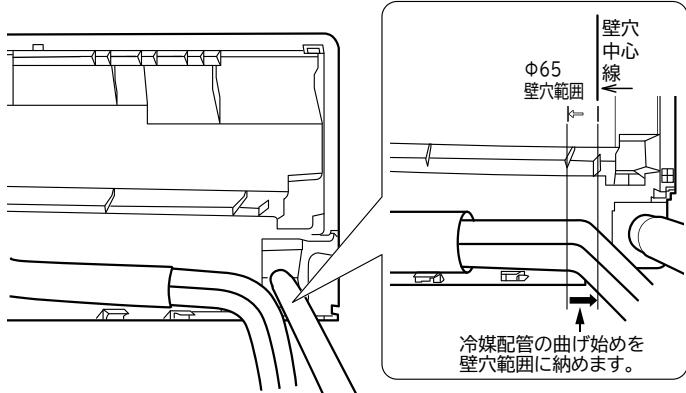
冷媒配管の曲げ始めが壁穴範囲から出でていたり、曲げRが大きいと、室内機が壁から浮き上がり、仕上りが悪くなる原因となります。
