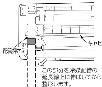
この部分を冷媒配管の延長線上に伸ばしてから整形します。
