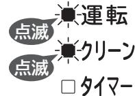
室内機凍結洗浄が動作します
