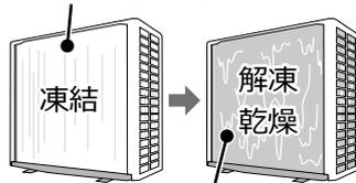
霜を溶かして、熱交換器の汚れを洗い流します
