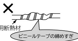
保冷用断熱材を使わなければ保冷用断熱材のビニールテープ巻きを締めすぎると…。 ⇒ 断熱効果がなくなり露が付き露たれおよび壁にシミやカビが発生します。
