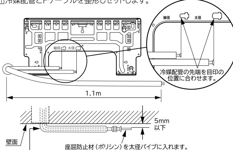
できるだけ小さなRで曲げてください(座屈防止材(ポリシン)を使用すると配管を潰さずに小さなRで曲げることができます)。 $\phi 12.7$ (1/2インチ)のパイプはベンダーを使用すると配管を潰さずに小さなRで曲げられます。
