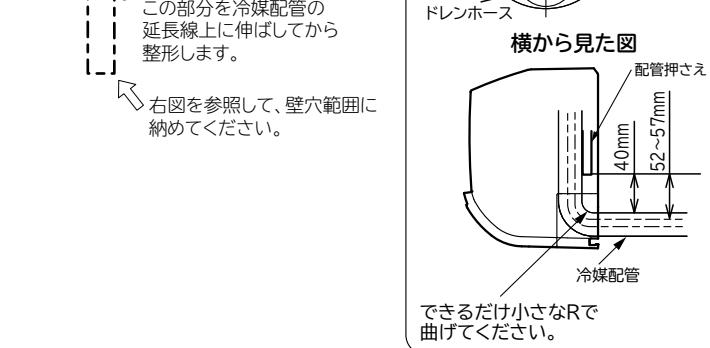
冷媒配管の曲げ始めが壁穴範囲から出でていたり、曲げRが大きいと、室内機が壁から浮き上がり、仕上りが悪くなる原因となります。
