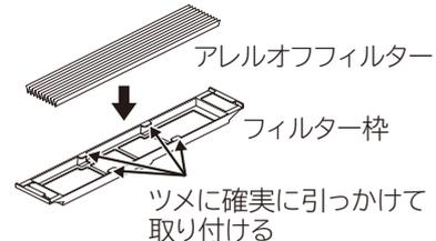
フィルター枠をエアフィルターの裏側に取り付ける
