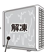
霜を溶かして、熱交換器の汚れを洗い流します
