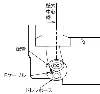
冷媒配管の曲げ始めが壁穴範囲から出ていたり、曲げRが大きいと、室内機が壁から浮き上がり、仕上りが悪くなる原因となります。
