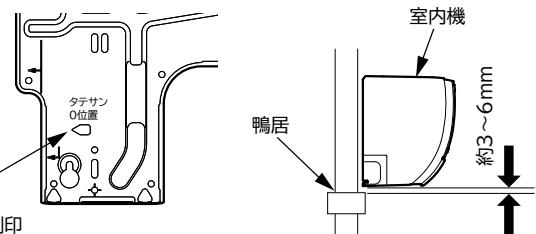
「たてさん」を使用して、室内機の背面で冷媒配管を接続する場合は、下の図のように実行してください。
