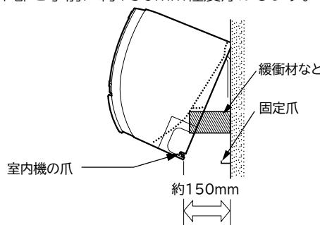
※室内機の下部を手前に浮かして、室内機の背面で冷媒配管を接続する作業が難しい場合があります。この場合は、当据付説明書P.15に記載しています「フロントパネル・化粧カバーの着脱のしかた」を参考し、化粧カバーを取り外して配管の接続を実施してみてください。
