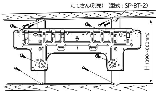
①据付板の刻印“タテサン0位置”を「たてさん」上の目盛り“0”に合わせると室内機と鴨居の隙間が小さくきれいに仕上がります。
