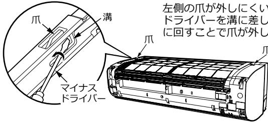
左側の爪が外しにくいときは、マイナスドライバーを溝に差し込み、反時計回りに回すことで爪が外しやすくなります。
