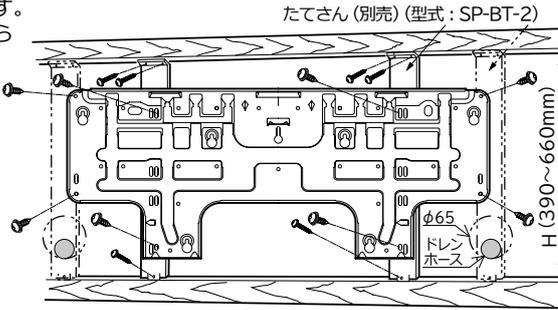
①据付板の刻印「タテサン0位置」を「たてさん」上の目盛り「0」に合わせて室内機と鴨居の隙間が小さくきれいに仕上がります。
