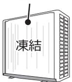
霜を溶かして、熱交換器の汚れを洗い流します
