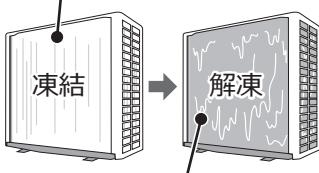
霜を溶かして、熱交換器の汚れを洗い流します
