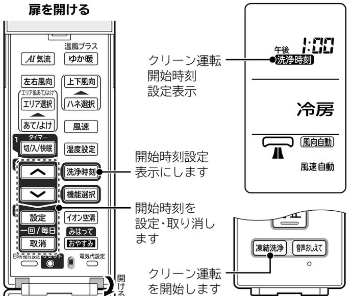
自動クリーン運転(フィルター掃除、室内機凍結洗浄)
