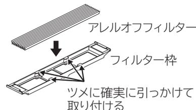
フィルター枠をエアフィルターの裏側に取り付ける
