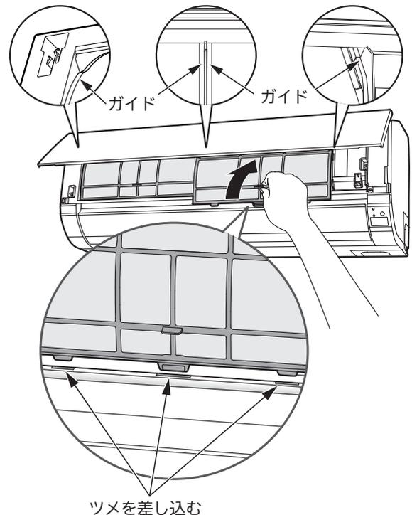
エアフィルターを取り付けて、フロントパネルを閉じる
