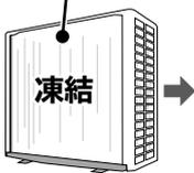
霜を溶かして、熱交換器の汚れを洗い流します
