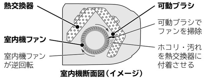
室内機凍結洗浄が動作します
