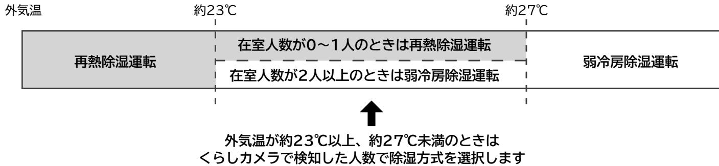
お部屋が暗いときなど、くらしカメラで人を検知できないときやくらしカメラを使用しない設定に変更した場合は、外気温25°C未満では再熱除湿運転、25°C以上では弱冷房除湿を運転します。
