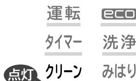
凍結洗浄と動作タイミングが重なったときは、クリーンランプと洗浄ランプが点灯します。
