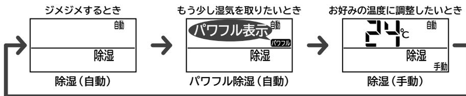
除湿 (自動) 運転開始時に目標にする温度を運転開始時の室温-2℃に設定します。
