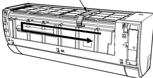
※イラストは説明のため、フロントパネルを取り外しています。けがや故障の原因になりますので、フィルター掃除ユニットが動作中は、フロントパネルを開けたり、取り外したりしないでください。
