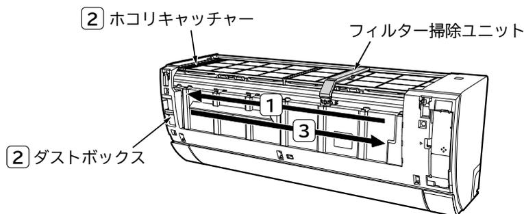
説明のため、フロントパネルを取り外しています。けがや故障の原因になりますので、フロントパネルを取り外したり開けたままで、フィルターの掃除をしないでください。
