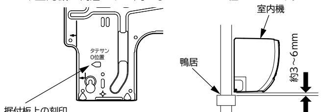
「たてさん」を使用して、室内機の背面で冷媒配管を接続する場合は、下の図のよう施行してください。
