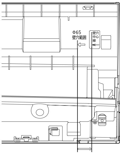
冷媒配管の曲げ始めが壁穴範囲から出でていたり、曲げRが大きいと、室内機が壁から浮き上がり、仕上りが悪くなる原因となります。
