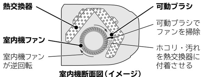
室内機凍結洗浄が動作します
