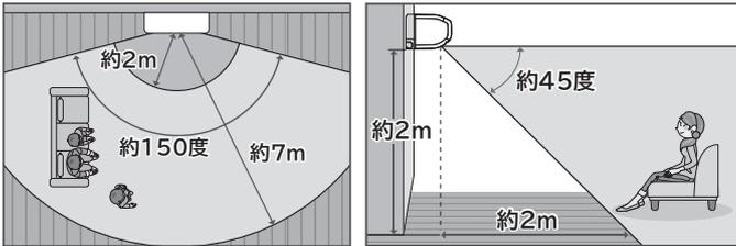
※温度カメラは天井の温度も検知します。
