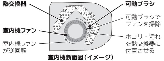
室内機凍結洗浄が動作します
