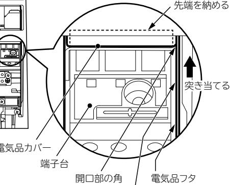
突き当てたときに先端部が電気品カバーに納まっていることを確認して固定ねじで取り付けます。
