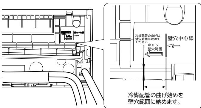
冷媒配管の曲げ始めが壁穴範囲から出でていたり、曲げRが大きいと室内機が壁から浮き上がり、仕上りが悪くなる原因となります。
