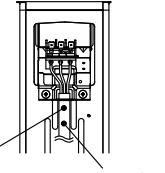
●取り外した端子台カバーは工事後、必ず取り付ける
