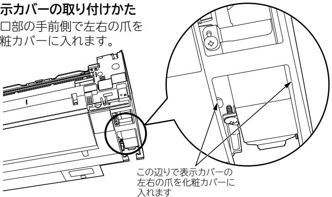
左右の爪を入れたあと、表示カバーをスライドさせて、下側の爪と誤挿入防止用の爪を化粧カバーに差し込みます。
