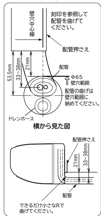
配管の曲げ始めが壁穴範囲から出ていると、曲げRが大きいと、室内機が壁から浮き上がり、仕上りが悪くなる原因となります。
