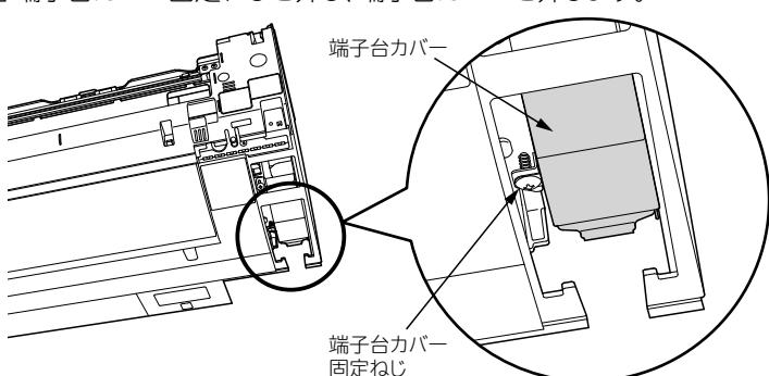
⑤ ケーブル固定ねじをゆるめ、ケーブル固定バンドを外して、Fケーブルを接続し、ケーブル固定バンドで固定します。
