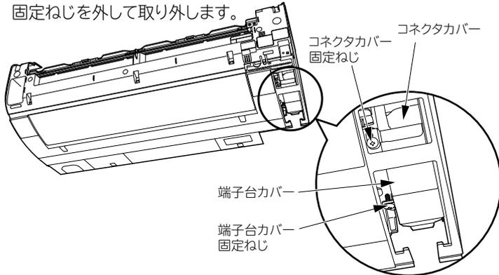
②HA接続コード・カードキーはCN6、RACアダプター・HEMSアダプターはCN7に接続されている室内機内蔵の遠隔操作機能 (白くまくん アプリ) 用コネクタを外して、コネクタをCN7に接続し、下図のように、ケーブルクリップで固定します。
