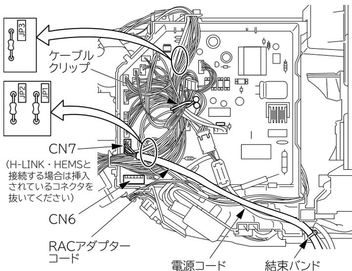
●上図はCN7にH-LINKを接続し、配線した時の例
