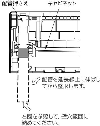
配管の曲げ始めが壁穴範囲から出ていると、曲げRが大きいと、室内機が壁から浮き上がり、仕上りが悪くなる原因となります。
