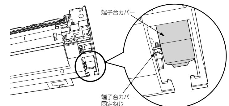
⑤ ケーブル固定ねじをゆるめ、ケーブル固定バンドを外して、Fケーブルを接続し、ケーブル固定バンドで固定します。
