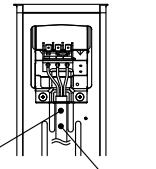
●取り外した端子台カバーは工事後、必ず取り付ける
