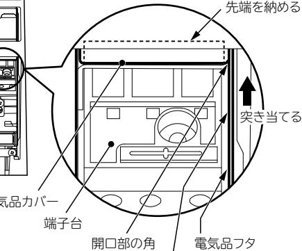
突き当たったときに先端部が電気品カバーに納まっていることを確認して固定ねじで取り付けます。
