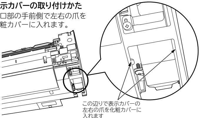
左右の爪を入れたあと、表示カバーをスライドさせて、下側の爪と誤挿入防止用の爪を化粧カバーに差し込みます。
