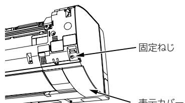
フロントパネルを閉めるときは、フロントパネルの左右2カ所を「カチッ」と音がするまで押し付けてください。
