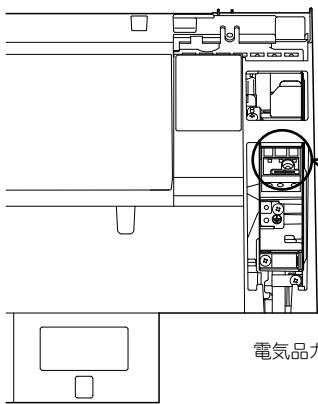
端子台カバー右上の切り欠きに電気品フタを差し込み、端子台カバーの先端が電気品カバーに納まるように開口部の角に突き当ります。
