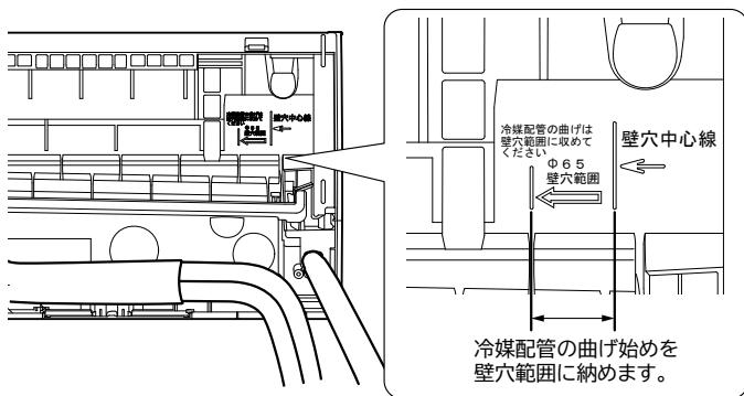
冷媒配管の曲げ始めが壁穴範囲から出でていたり、曲げRが大きいと室内機が壁から浮き上がり、仕上りが悪くなる原因となります。
