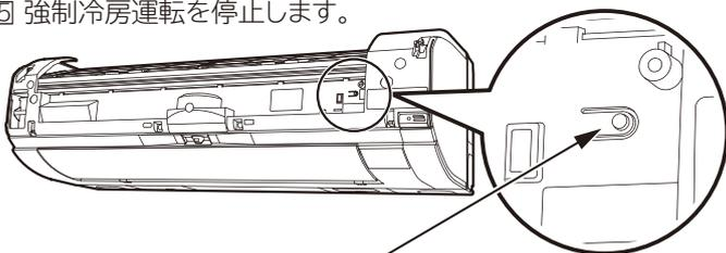
（5秒以上押し続けると強制冷房運転を開始します。止めるときは、もう一度押すか、リモコンで運転を停止してください）
