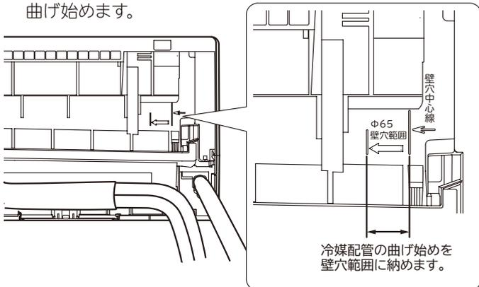
冷媒配管の曲げ始めが壁穴範囲から出ていたり、曲げが大きいと、室内機が壁から浮き上がり、仕上りが悪くなる原因となります。
