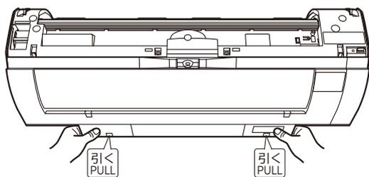
●なげし等で室内機底面内側を下に押しえない場合は、化粧カバーを外し、図のように取り外し用の穴に指を入れ、①穴の下部を押しながら②室内機を手前に引っ張ります。
