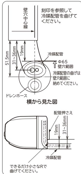
冷媒配管の曲げ始めが壁穴範囲から出ていたり、曲げRが大きいと、室内機が壁から浮き上がり、仕上がりが悪くなる原因となります。
