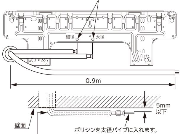
できるだけ小さなRで曲げてください (ポリシンを使用すると配管を潰さずに小さなRで曲げることができます)。
