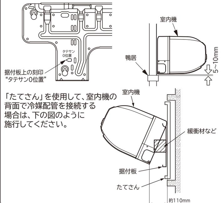
「たてさん」を使用して、室内機の背面で冷媒配管を接続する場合は、下の図のように施行してください。
