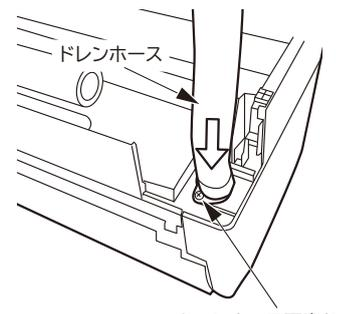
ドレンホース固定ねじ (Drain hose fixing screw)
