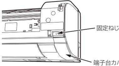
フロントパネルを閉めるときは、フロントパネルの左右2カ所を「カチッ」という音がするまで押し付けてください。
