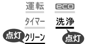
リモコンを操作してもクリーン運転ができないときは「ピーー」と鳴り、洗淨ランプが点滅します
