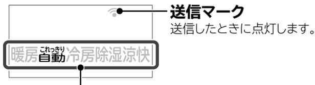
運転停止中は前回停止した運転の種類を表示します
