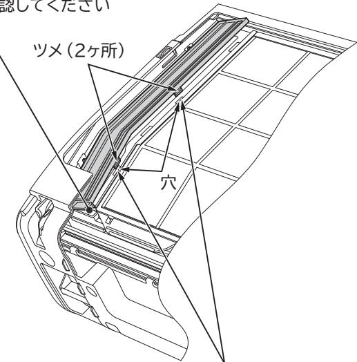
ホコリキャッチャーを押し付けることで、ホコリキャッチャーのツメ(2ヶ所)が穴に入り、ホコリキャッチャーが固定されます
