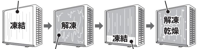
霜を溶かして、熱交換器の汚れを洗い流します
